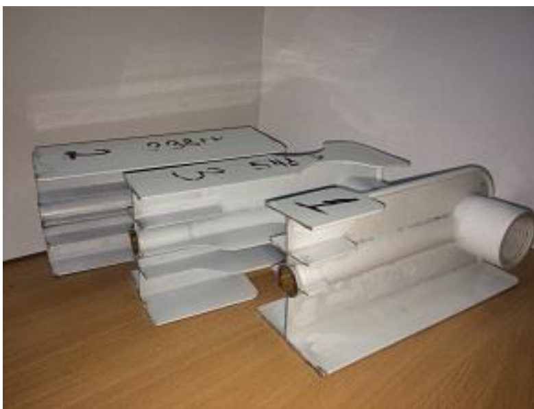
Рис. 2. Вид фрагментов конструкции радиатора после механического разделения.
